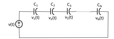
KVL:  $v(t) = v_1(t) + v_2(t) + v_3(t) + ... + v_N(t)$
